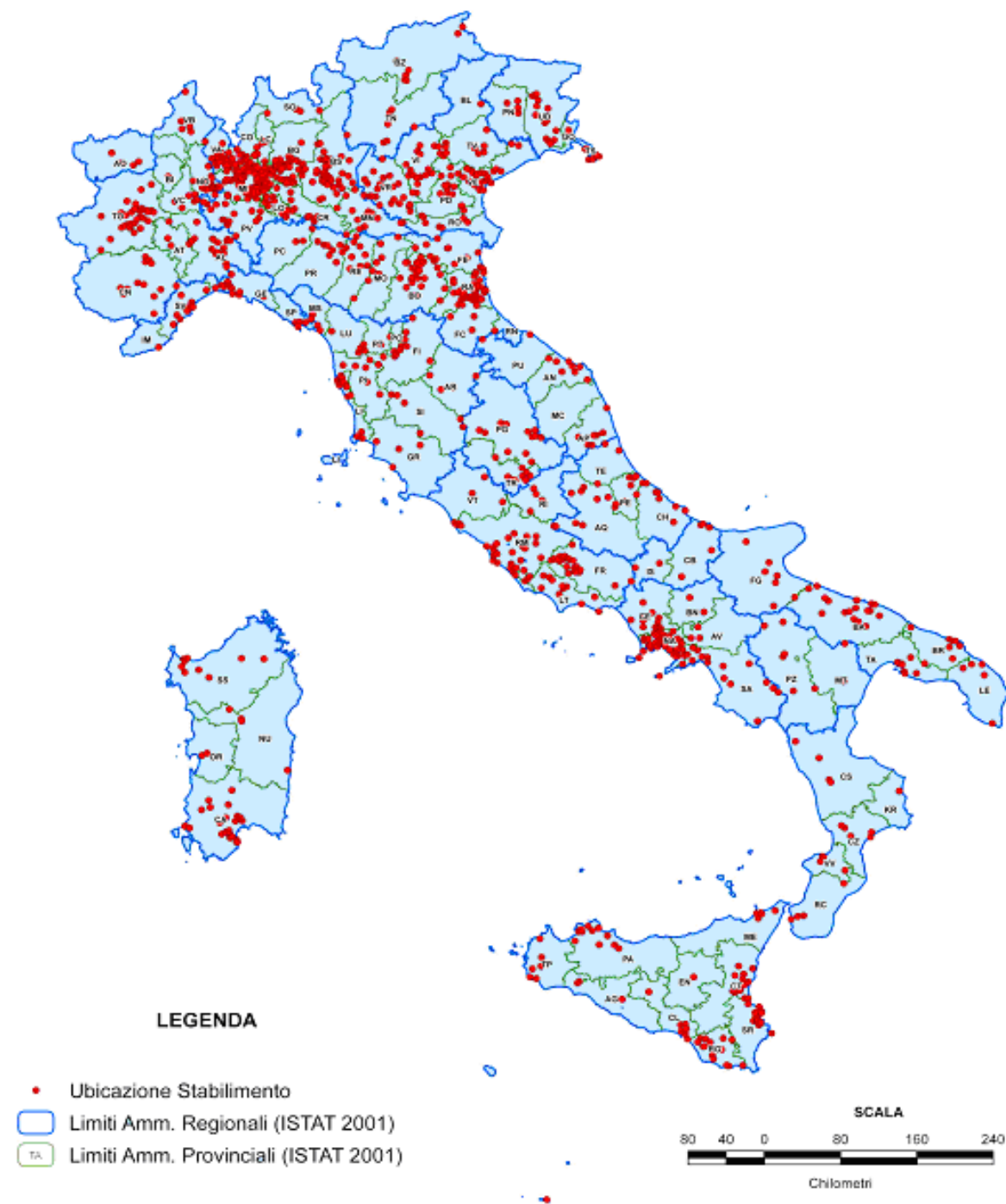
Fig. 4 – Localizzazione degli stabilimenti a rischio di incidente rilevante. Si noti la concentrazione di impianti anche in aree ad elevata sismicità (ad esempio, Sicilia sud-orientale, Napoli)
